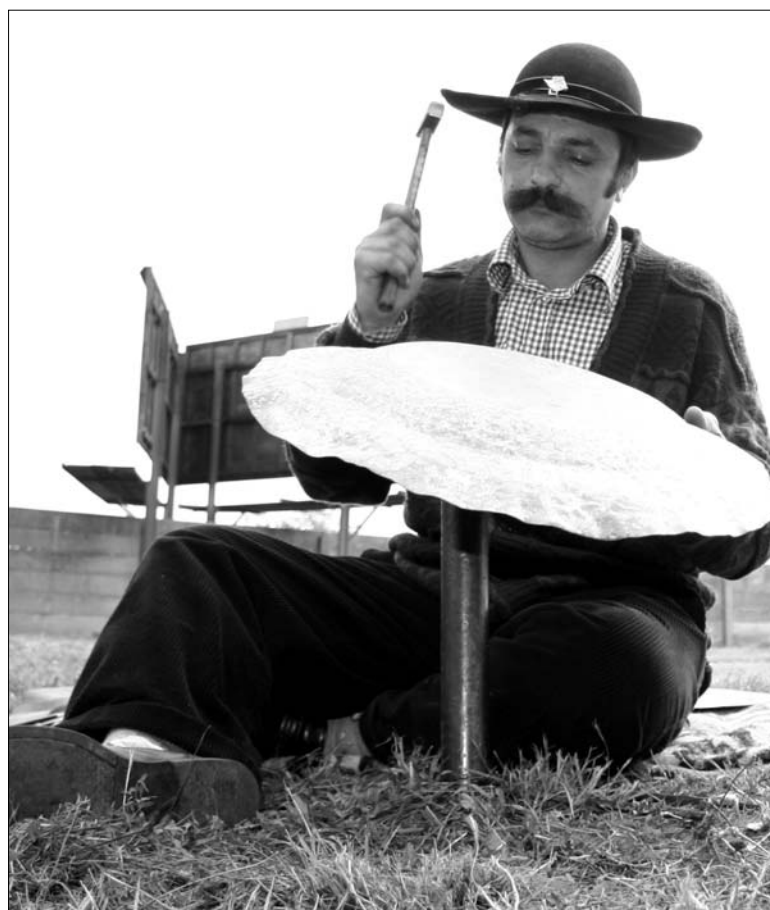
Rumunský kotlář pracuje na přenosné kovadlině, jež se zapichne kdekoliv do země
